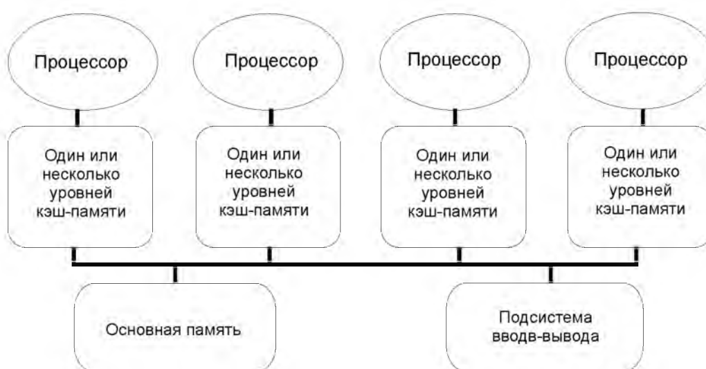
Рисунок 2.9 - Типовая архитектура мультипроцессорной системы с общей памятью
