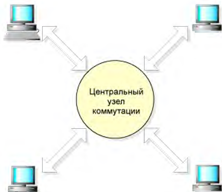
Рисунок 4.1-Звёздообразная топология сети
