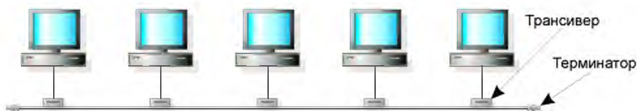
Рисунок 4.3-Шинная топология сети
